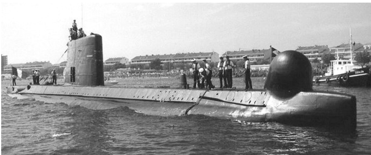
Un 800 tonnes type Daphné. La Psyché et la Sirène avaient un dôme sonar du type Narval.
